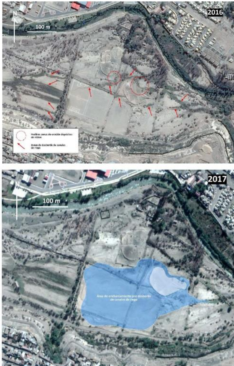
Evidencias de desbordes y encharcamiento del entorno de Planta Torino por efecto de activación de canales de riego
